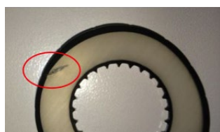
Muestra 2: Daños durante la instalación
