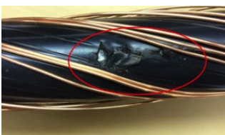
Muestra 1: Sin continuidad en la capa semiconductora exterior
