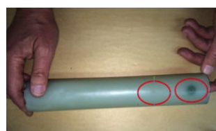
Muestra 3: Contaminantes introducidos durante la fabricación
